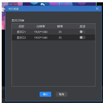
“设置-NDI 发送”弹出上图对话框，支持打开各显示口的发送开关，并支持设置发送的分辨率和帧率。
