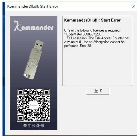
故障原因：加密锁自带检测程序，可能其认为用户正在使用破解工具解密，则自动调用锁定程序，将自己锁住。
