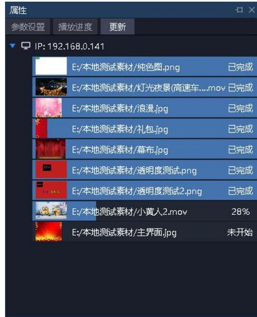
主备多联机同步媒体文件时显示文件的传输状态，方便用户查看正在同步的、未开始、同步失败的文件以及了解传输是否完成。
